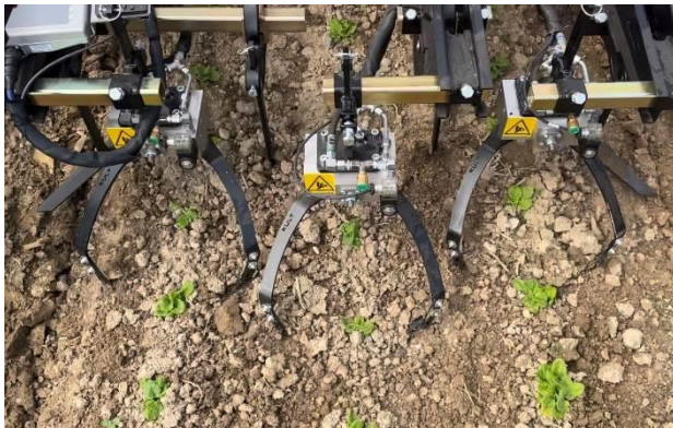
Illustration 2 : Outils de binage in-row du iSelect. Photo : Tino Hedrich, FiBL
