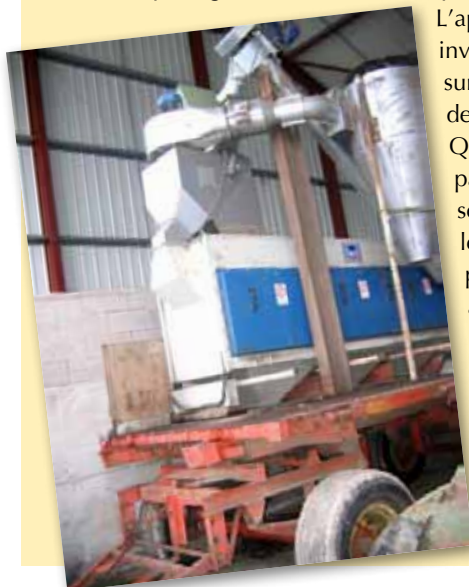
Installé sur une remorque, le trieur.
