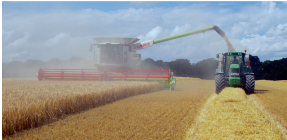
Récolte de céréales sur des voies de passage CTF permanentes en Grande-Bretagne – le plan de circulation protège le sol. (Source: Julian Gold, Hendred Farm Partnership)
