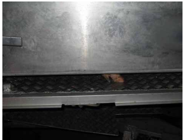
Protection latérale jusqu'à la hauteur des boulons: une protection supplémentaire contre les glissements latéraux n'est pas nécessaire.
