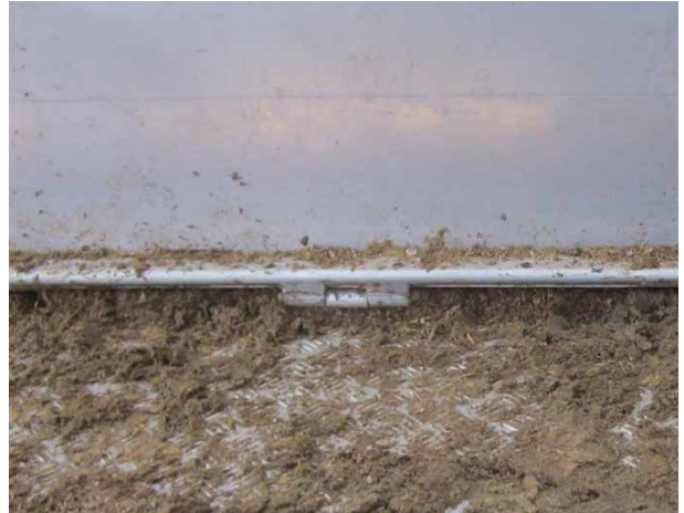
Fixation pour treillis de séparation sur une hauteur inférieure aux boulets des animaux: pas comptée dans la surface de chargement.
