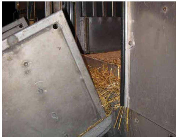
Espaces entre les parois de protection latérale et la paroi du véhicule.
