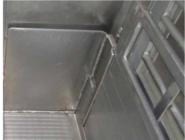
Les rebords latéraux évitent que les animaux se coincent entre les pièces mobiles.
