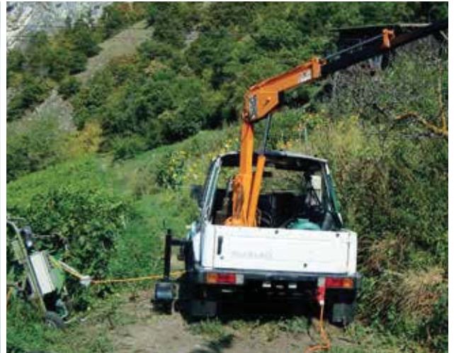
L'«électro-Beudon»: à gauche une vue du poste de pilotage, à droite le tout-terrain Suzuki à moteur électrique en pleine action. Sur la gauche de la photo on voit le chariot interlignes que la grue permet de transporter d'un interligne à l'autre. L'électricité provient de la centrale hydraulique privée du domaine.
