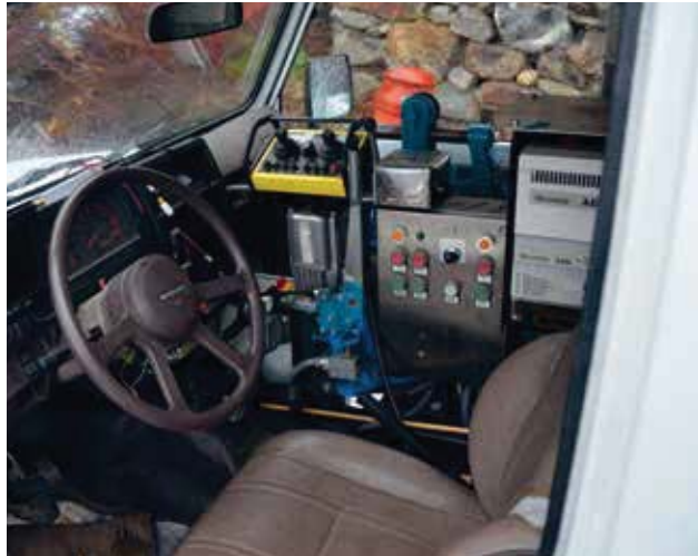
L'«électro-Beudon»: à gauche une vue du poste de pilotage, à droite le tout-terrain Suzuki à moteur électrique en pleine action. Sur la gauche de la photo on voit le chariot interlignes que la grue permet de transporter d'un interligne à l'autre. L'électricité provient de la centrale hydraulique privée du domaine.
