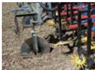
Pilotage des disques de guidage par des satellites, pas d'effet sur les lignes; guidage autonome; précision de +/- 2 cm, grande efficacité. Prix: 15 000.- Fr.
