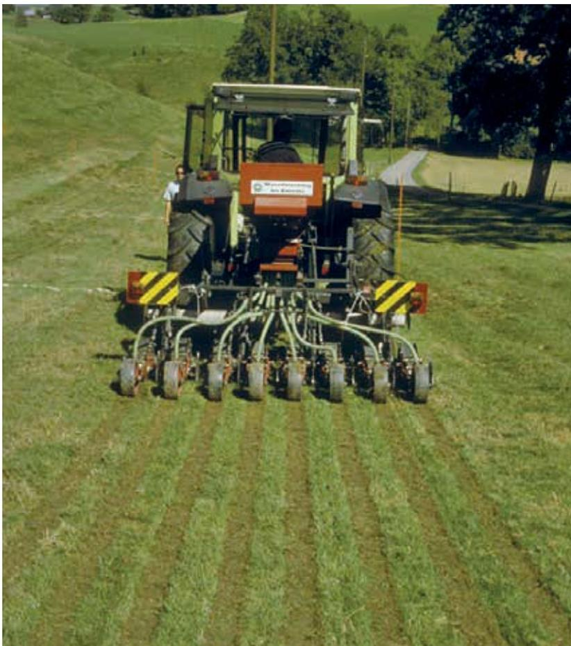
Le Vakutec Slotter fraise la prairie et dépose la semence avec un semoir pneumatique. Un rouleau à pneus tasse ensuite la bande fraisée et les graines semées.
