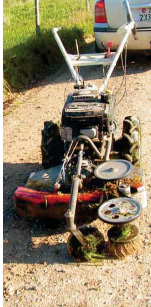
Cette «balayeuse» de marque homemade permet aux Spaltenstein de maintenir propres les bandes de bâche tissée posées sur les lignes.
