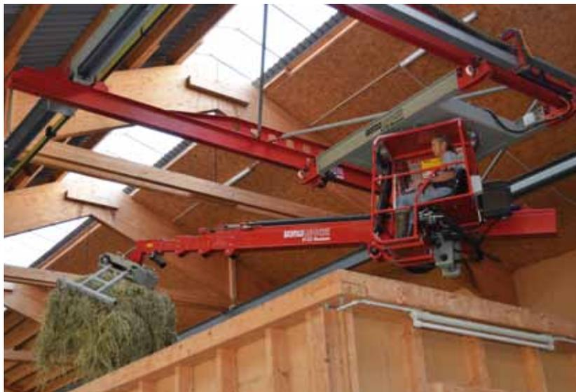
La griffe à fourrages sur pont roulant permet une très bonne rationalisation du stockage et du déstockage du foin et de la paille.
