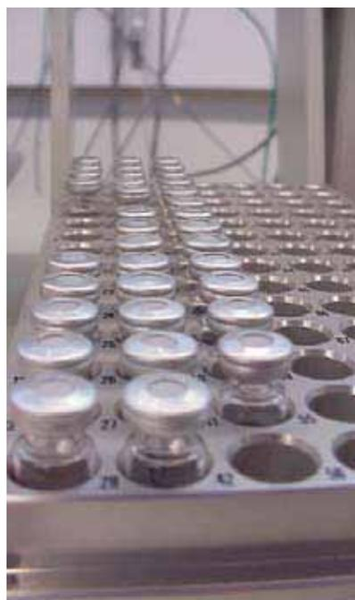
Les échantillons placés dans l'échantillonneur automatique du chromatographe en phase gazeuse.
