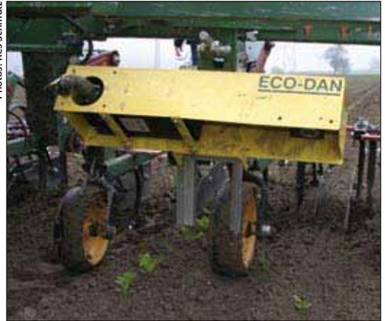
Les caméras installées dans le caisson jaune sont les yeux de la sarceuse.
