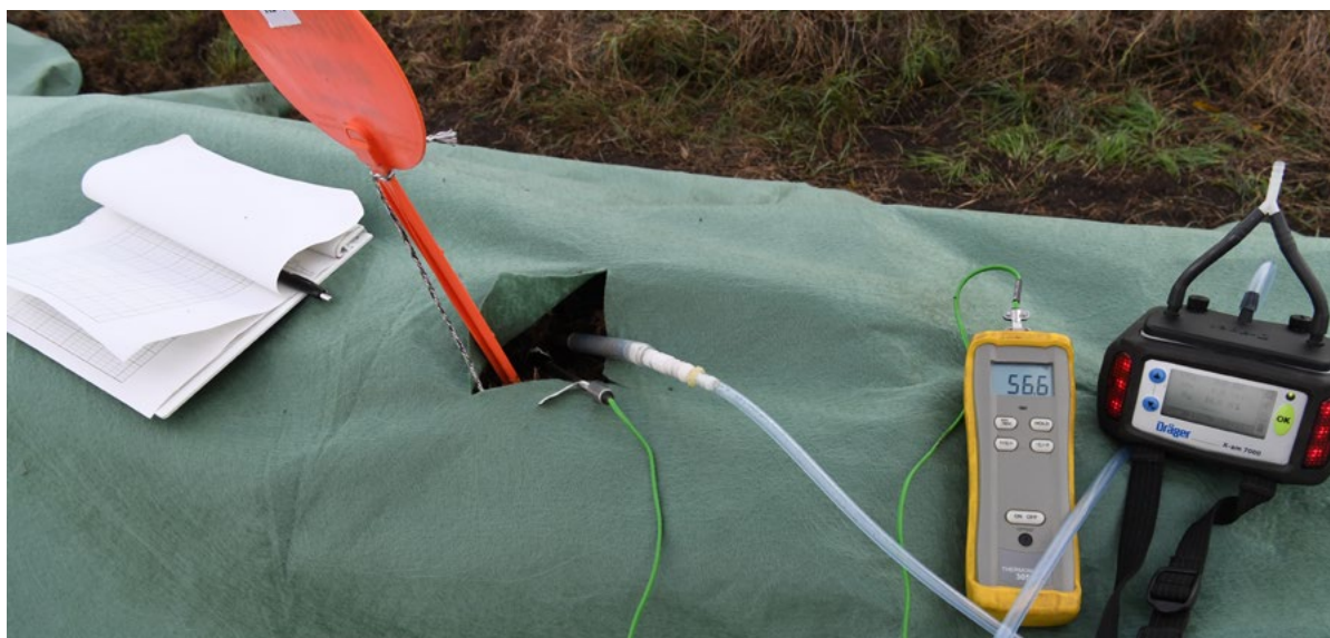
Instruments de mesure de la température et de la composition des gaz dans les meules de compost couvertes avec une bâche semi-perméable.
