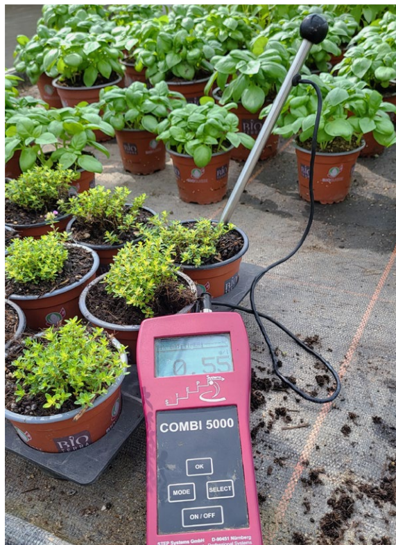
Mit der Schnellmessung mittels AM-Methode (Aktivierungsmesser) lässt sich der Salzgehalt kurzfristig überwachen. Dies gibt Auskunft über die gelösten Nährstoffe im Topf.
