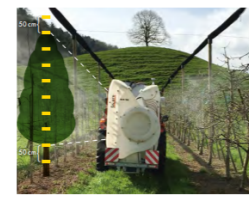
Bei gut angelegten Gassen ermöglicht ein gleichzeitiges Spritzeln über die ganze Baumreihe, vor der Baumreihe bis zu den untersten Trieben, ein Benetzen und auf der Blätter- und Unterseite.
