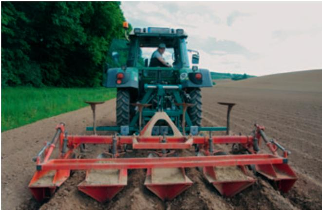
Fig. 6: En haut: Guidage arrière Trimble TrueTracker. Deux antennes permettent de maintenir le tracteur et l'outil attelé simultanément sur la voie. En bas: Le cadre de réglage hydraulique PSR Slide corrige les écarts de l'outil attelé. Source: Geo-Konzept, Reichhardt
